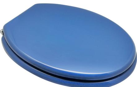
Sedile (cerniere tipo A). Dimensioni: Lunghezza cm 43-46; Larghezza cm 37; Interasse cerniere cm 13,5-18. Cerniere regolabili. Sedile in legno stabilizzato, colato in poliestere. Cerniere in ottone cromato e viti di fissaggio in acciaio inox. Sedile universale
