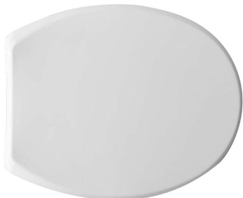
Sedile wc universale termoplastico in resina infrangibile Kg 1,200. Fissaggio rapido e sicuro con cerniera Uniblock a 4 regolazioni e viti in resina. Avvolgente, anatomico, igienico, riciclabile. Lunghezza cm 42-45; Larghezza cm 36,8; Interasse cm 13-18,5. Cerniere tipo A.
